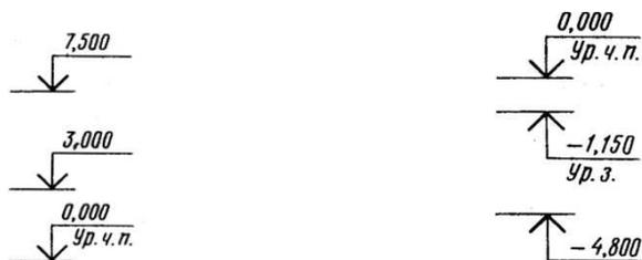
Рисунок 4.6 – Обозначение высот на чертеже
