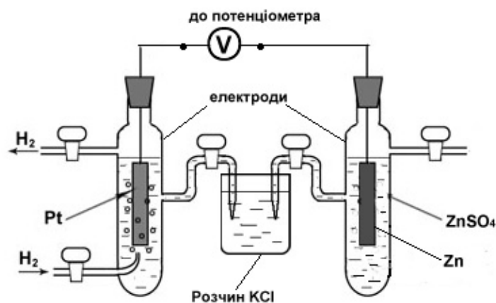
Рисунок 6 – Стандартний воднево-цинковий гальванічний елемент
