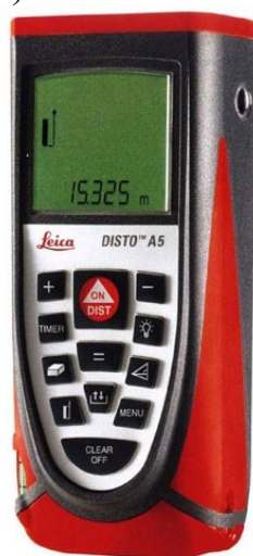
Рисунок 4 - Лазерна рулетка (далекомір).
