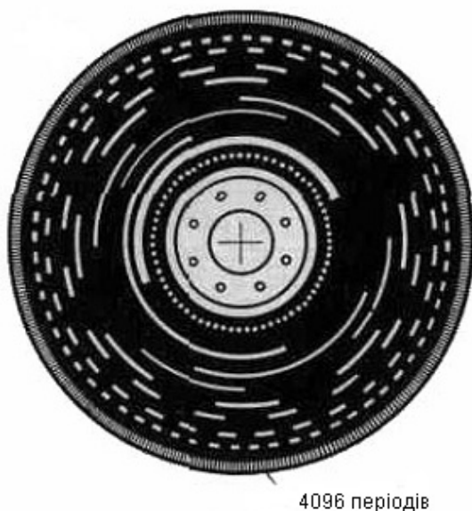
Рисунок 5 - Приклад кодованого круга в електронному теодоліті
