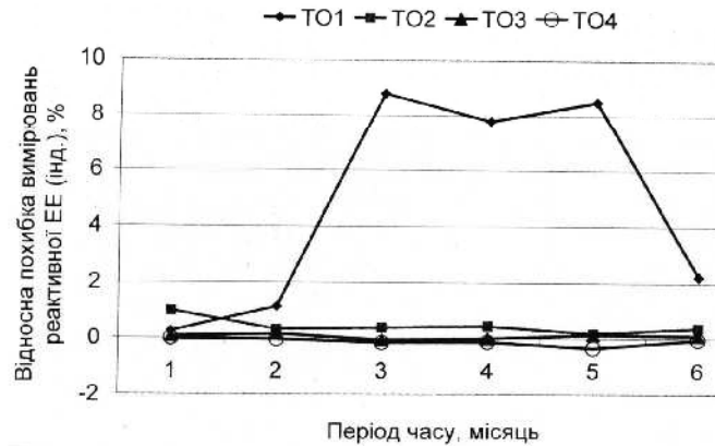
Рис. 3 – Графік залежності похибки вимірювань реактивної ЕЕ (індуктивний режим) від періоду досліджень
