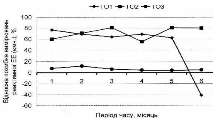
Рис. 11 – Динаміка похибки вимірювань реактивної ЕЕ (емнісний режим) за період дослідження 2- та 3-елементними ЛЕ різного типу
