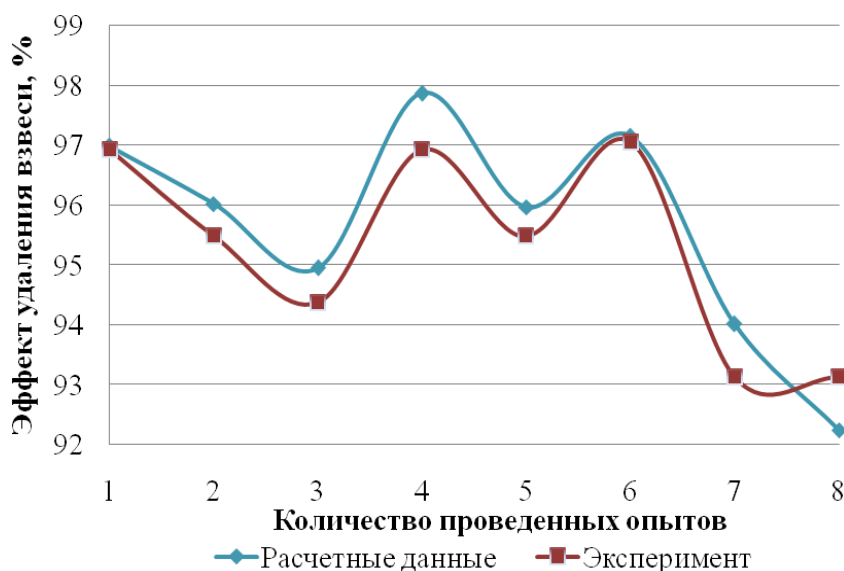
Рис. 1 – Сопоставление экспериментальных и расчетных данных эффекта удаления взвешенных веществ при применении усовершенствованной конструкции диафрагмы в узле смешения коагулянта (сульфата алюминия)
