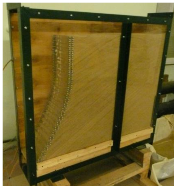
Рис. 10. Вид модельной установки (стенки из оргстекла и фанеры) в ходе испытаний.
