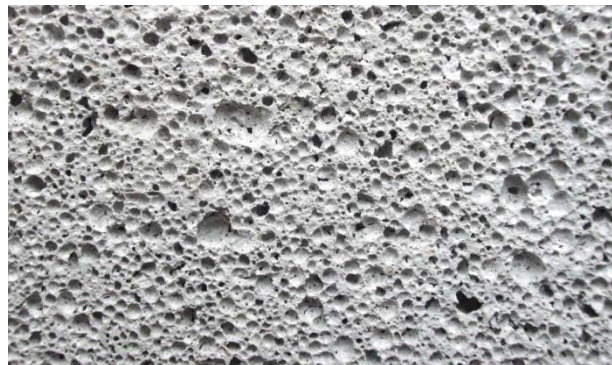
Фото.1. Макроструктура поверхности образца с применением молотого доменного шлака
