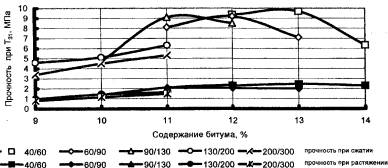
Рис.3 – Зависимость прочностных показателей модельных асфальтовых систем от содержания и марки битума
