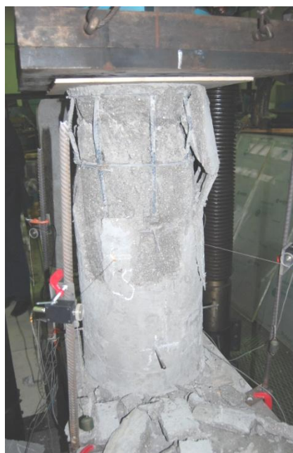
Рисунок 2 – Испытание фрагмента колонны
