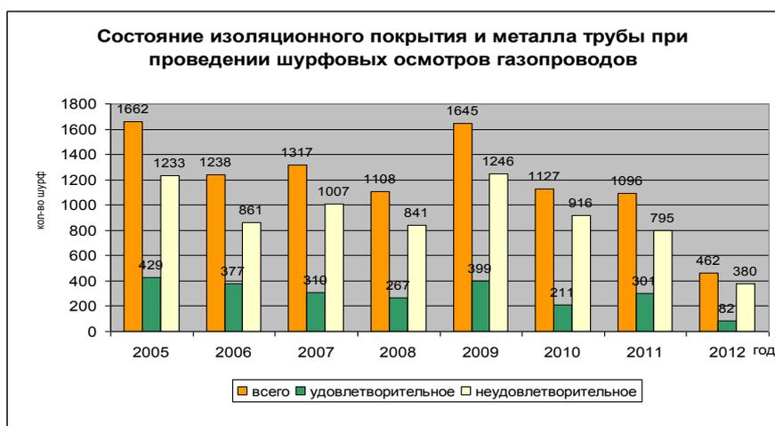
Рис.4 Техническое состояние изоляционного покрытия
