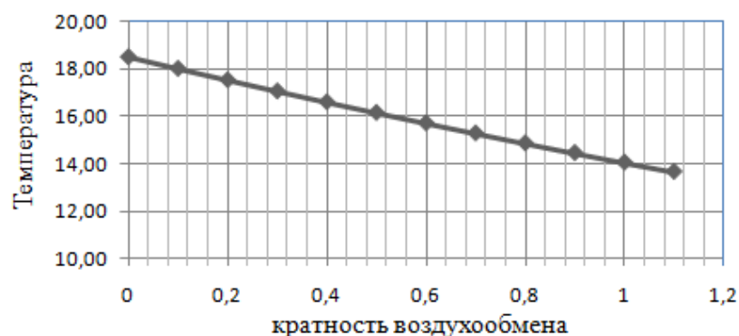
Рис. 2. Зависимость температуры рассматриваемой квартиры от воздухообмена
