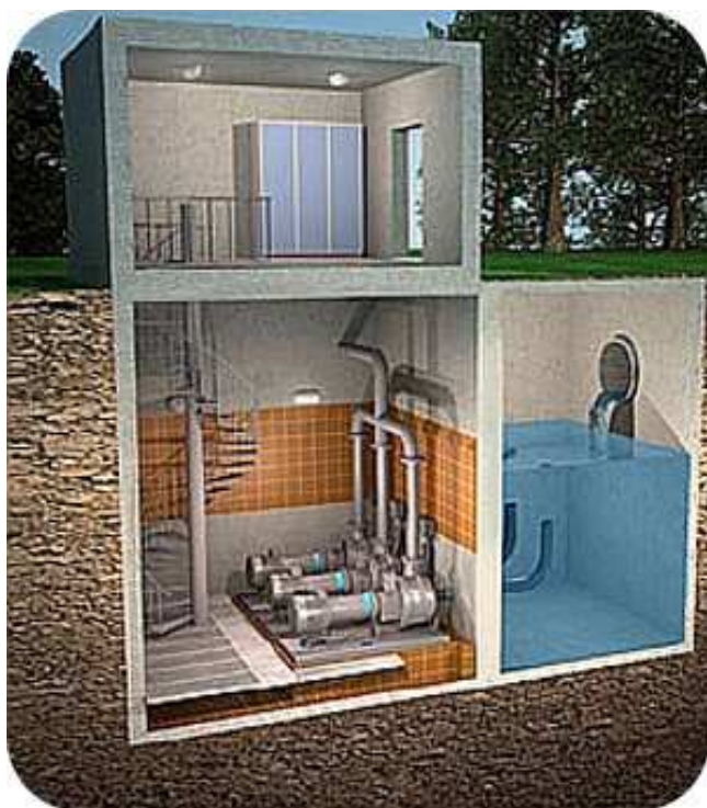
Рисунок 3.11 – Схеми компонування традиційних КНС (а) та КНС, виконаних з полімерних матеріалів (б)
