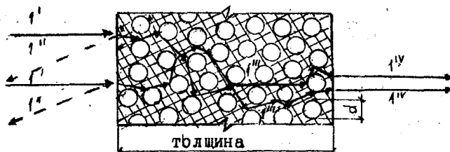
Рис.3 – Прохождение звуковой волны через мелкопористый материал при условии, что \ell > d
