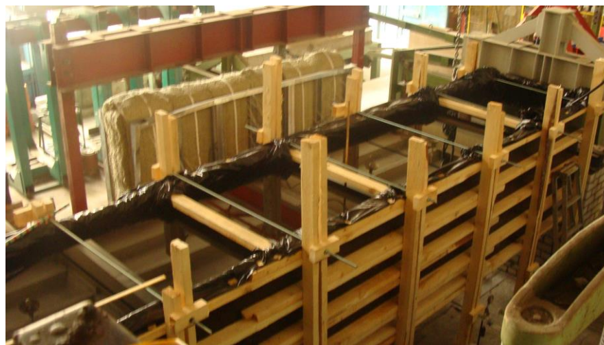
Рис. 7. Испытания плиты гидравлическим методом нагружения
