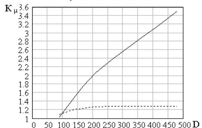
Рис.2. Зависимость коэффициента насыщения от наружного диаметра сердечника статора раскроемого по критерию максимальной энергии магнитного поля в зазоре — сплошная кривая и по критерию максимального магнитного потока — пунктирная кривая
