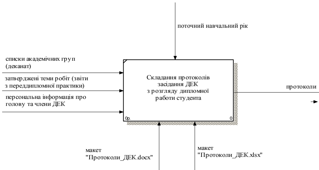
Рис. 5. Діаграма EDF0 процесу складання протоколів засідання ДЕКу з розгляду дипломної роботи студента
