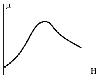
Рис. 6 – Графік залежності магнітної проникності від напруженості магнітного поля
