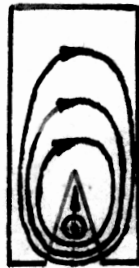
Рис.7.6 - Втягування дуги в сталеву решітку
