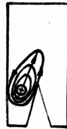
Рис. 7.7 - Траєкторія опорної точки дуги на сталевій пластині
