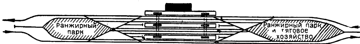
Рис. 3.26 – Схема прохідної пасажирської станції з боковим розташуванням вокзалу
