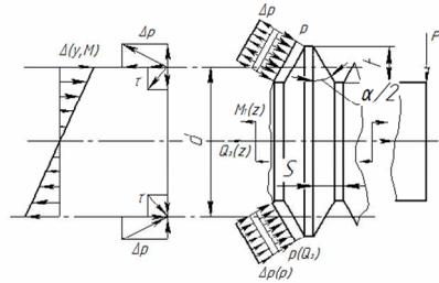
Рис. 2 – Распределение контактных давлений при изгибе резьбового соединения
