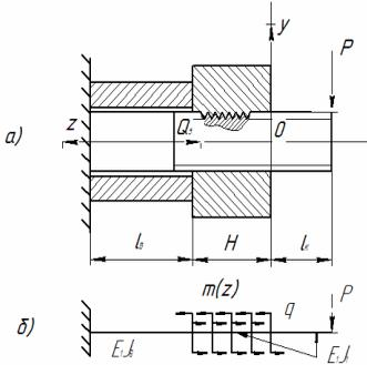
Рис. 1 – Конструктивная (а) и расчетная (б) схема резьбового соединения при изгибе
