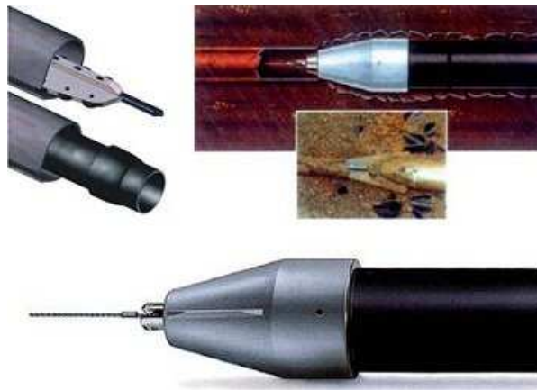
Рис. 18.12 - Інструменти для вскриття ремонтуємого трубопроводу
