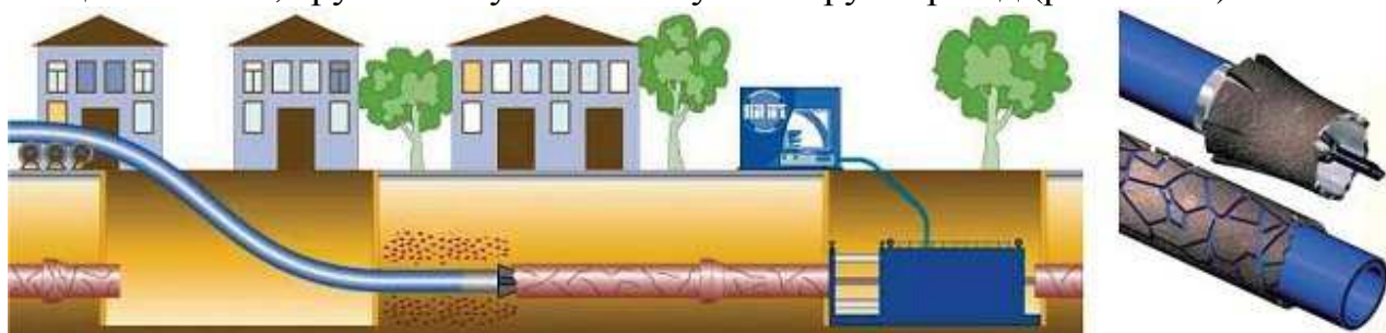
Рис. 18.10 - Протягування поліетиленової труби з руйнуванням існуючого трубопроводу
