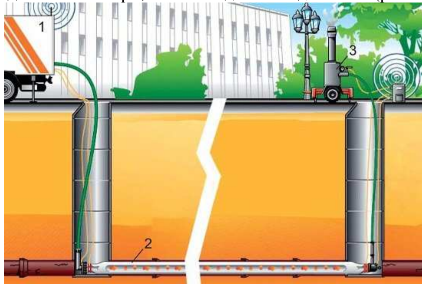
Рис. 18.9 - Процес обробки парою поліетиленового рукава U-образної форми для переводу його в первісний (круглий) стан 1 - парогенераторна установка; 2 - рукав, наповнений паром під тиском; 3 - сепаратор конденсату
