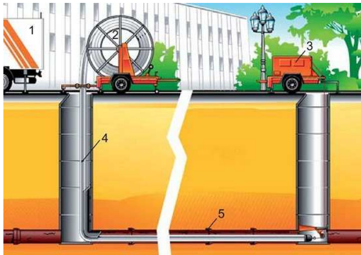
Рис. 18.8 - Процес установки поліетиленового рукава за технологією Compact Pipe 1 - парогенераторна установка; 2 - причіп для барабану; 3 - лебідка; 4 - поліетиленовий рукав; 5 - ремонтуємий трубопровід.
