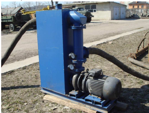
Рис. 1 – Общий вид универсальной установки локального вакуумного водопонижения ПУВВ – 5М
