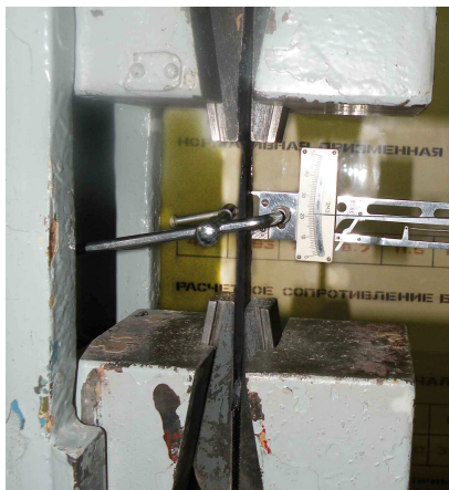
Рис. 6 – Общий вид испытаний базальтопластиковой арматуры с хаотичным наполнением на растяжение
