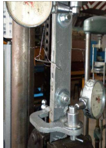
Рис. 7 – Зразок у пресі УИМ-50
