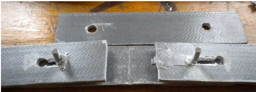
Рис. 8 – Характер руйнування болтового з'єднання
