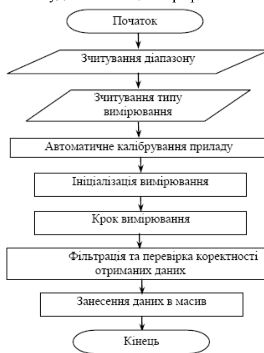
Рис. 2 - Блок-схема алгоритму взаємодії з приладом
