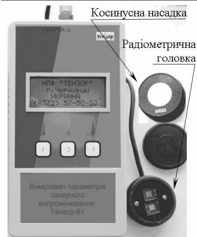
Рис. 2 - Зовнішній вигляд вимірювача параметрів лазерного випромінювання з радіометричними головками на УФ діапазон спектру, виконаного за першою концептуальною схемою.
