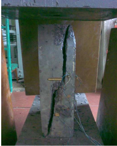
Рис.1 – Характер руйнування дослідної призми
