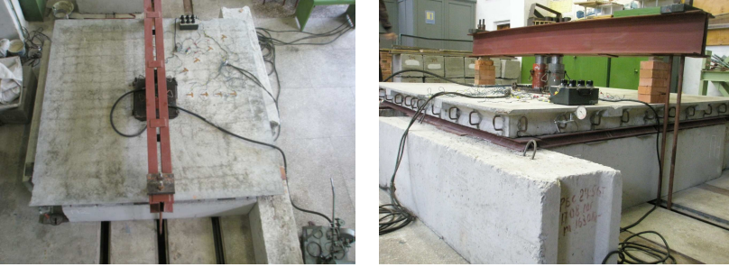
Рис.3 – Експериментальна установка з надколону плитою під час випробування (фото)
