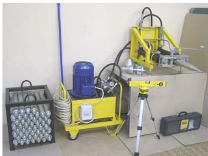
Рис. 3. Комплект оборудования прокольной установки МП-250
