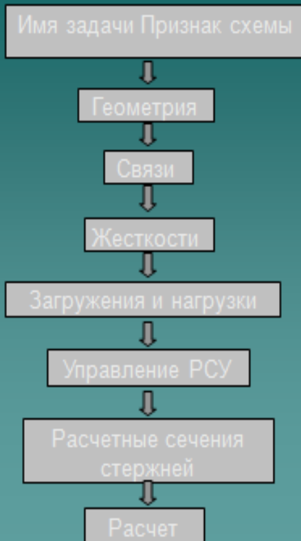
Рис.7.3 – Формирование расчетной модели.
