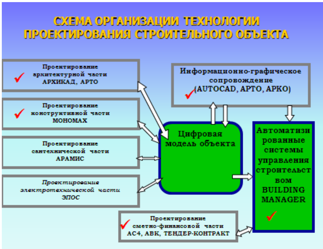
Рис.6.3 – Схема организации проектирования.
