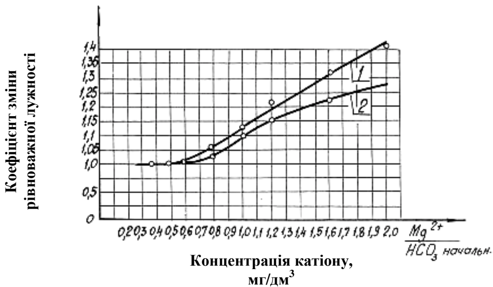
Рис. 2.3 - Вплив концентрації магнію на стабільність води (1 – вплив хлористого магнію, 2 – вплив іона магнію після вилучення впливу іону хлору)
