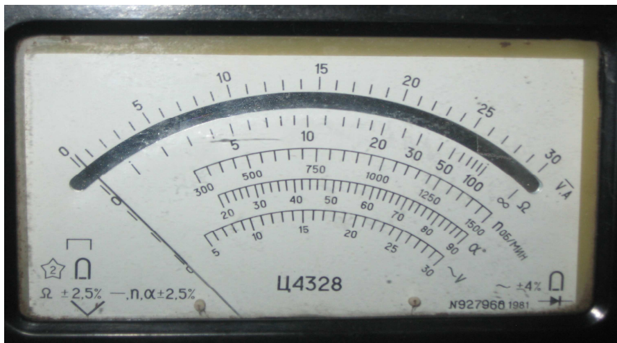
Рис. 2 – Комбінований прилад Ц4328 для вимірювання сили електричного струму, електричної напруги, електричного опору
