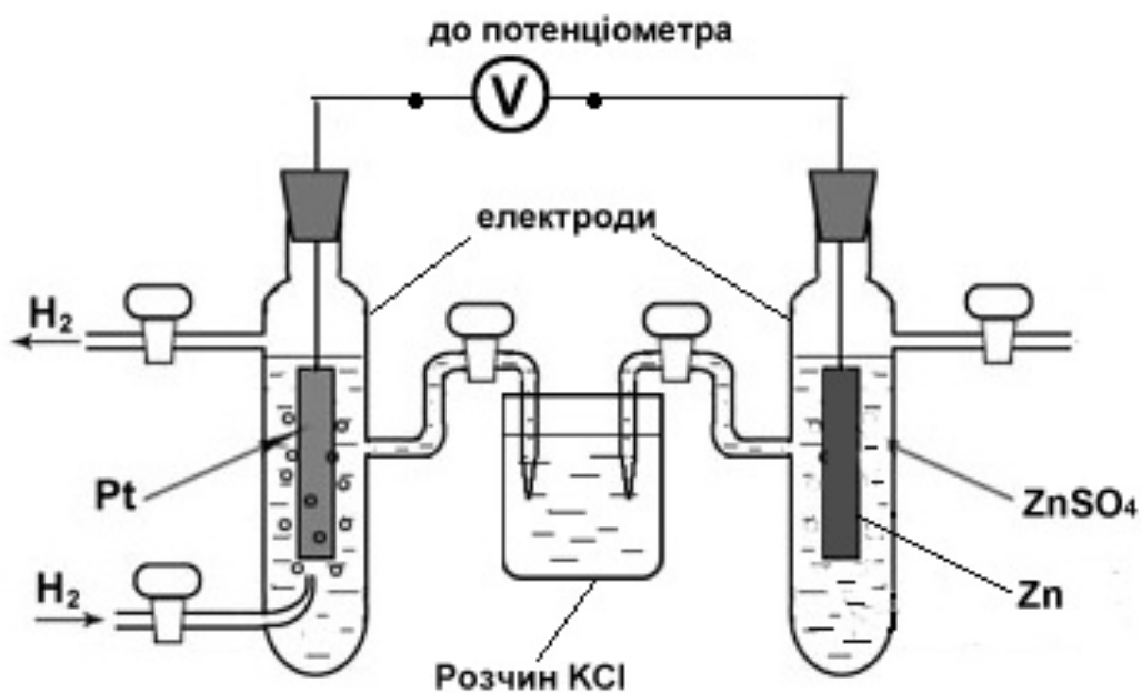
Рис. 6 – Стандартний воднево-цинковий гальванічний елемент
