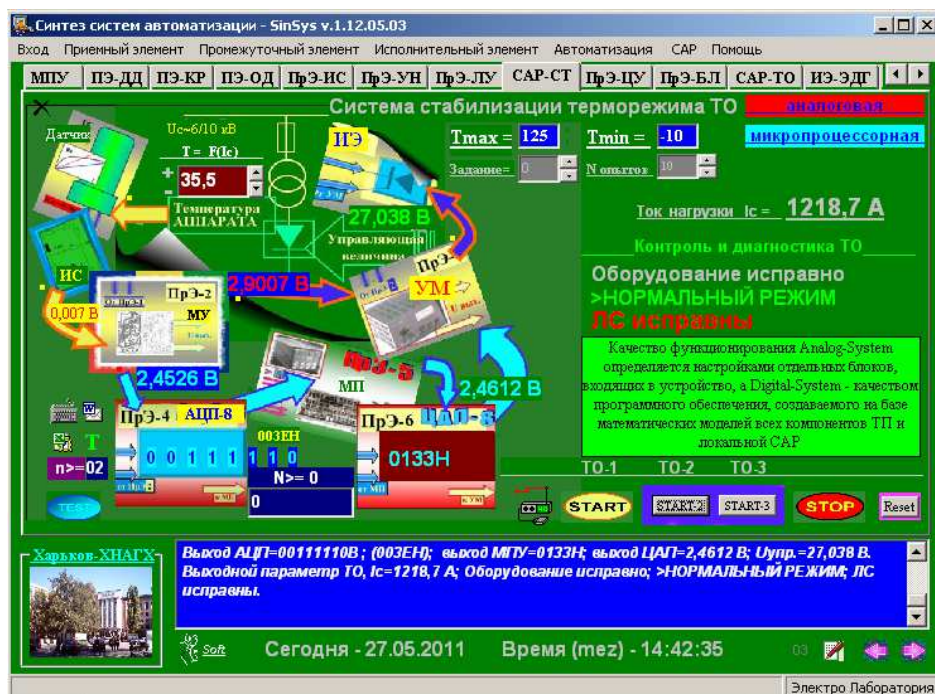
Рис.2.13 – Лабораторний стенд «САР-СТ» в пакеті програм SinSys
