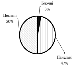
Рис. 2 – Огороджуючі конструкції (зовнішні стіни) будинків перших масових серій
