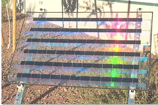
Рис. 1 Внешний вид солнечной батареи с голографическим концентратором.
