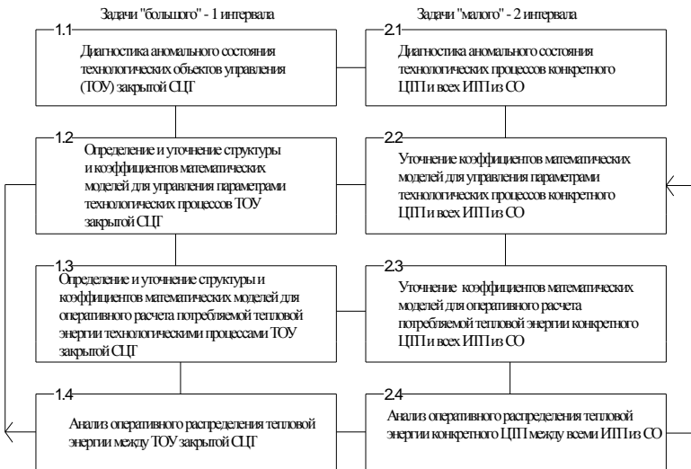
Функциональная схема алгоритма решения задач оперативного распределения тепловой энергии между ТОУ закрытой СЦТ
