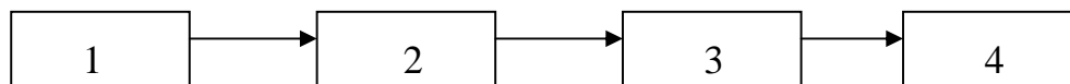
Рисунок 7.2 — Блок - схема установки для вимірювання спектральної чутливості: 1 - джерело світла з відомою температурою тіла розжарювання (джерело типу А); 2 - спектральний прилад (монохроматор УМ-2); 3 - приймач випромінювання, що досліджується; 4 - прилад, що вимірює фототок (мікроамперметр)
