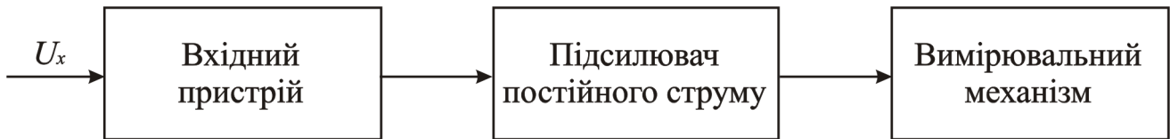
Рис. 5.1 – Структурна схема електронного вольтметра постійного струму
