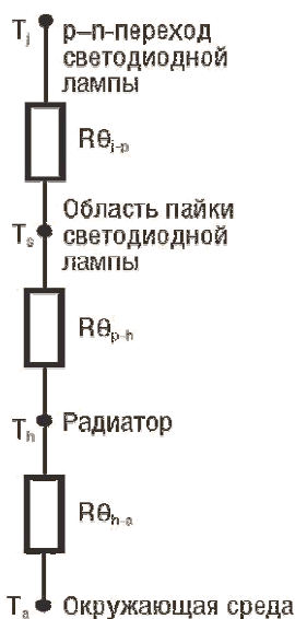
Рис. 4 - Тепловая модель светодиода, установленного на радиатор
