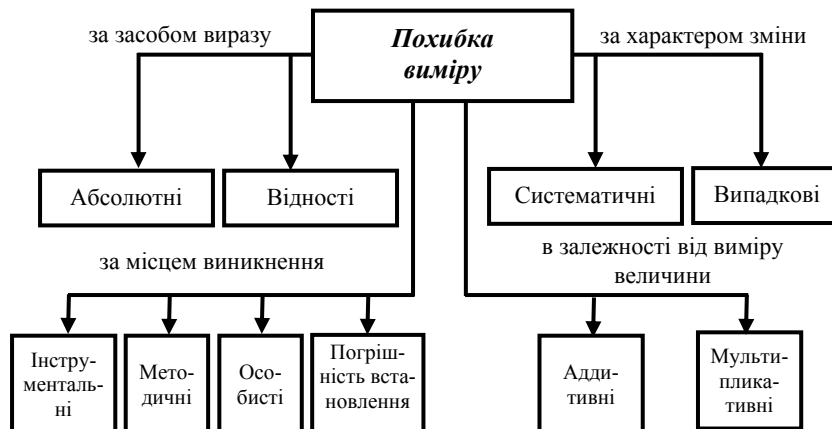
Рис.5.- Схема класифікації похибок виміру
