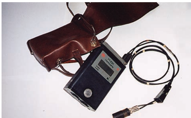
Рис. 2.7. Переносной ультразвуковой толщиномер УТ-93 П
