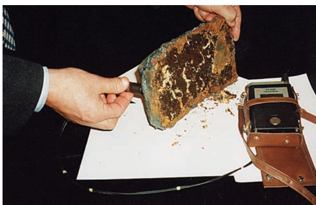
Рис. 2.8. Измерение с помощью толщиномера УТ-93 П толщины инкрустированного образца, взятого с водовода диаметром 1400 мм
