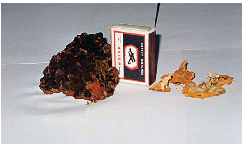
Рис. 3.11. Соскоб наростов с внутренней поверхности водовода: a – пятно соскоба; б – нарост в сравнении с высотой спичечной коробки
