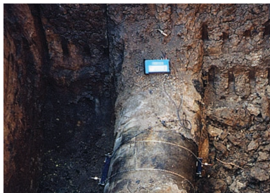
Рис. 2.3. Измерение скорости и расхода воды в водоводе диаметром 1200 мм
