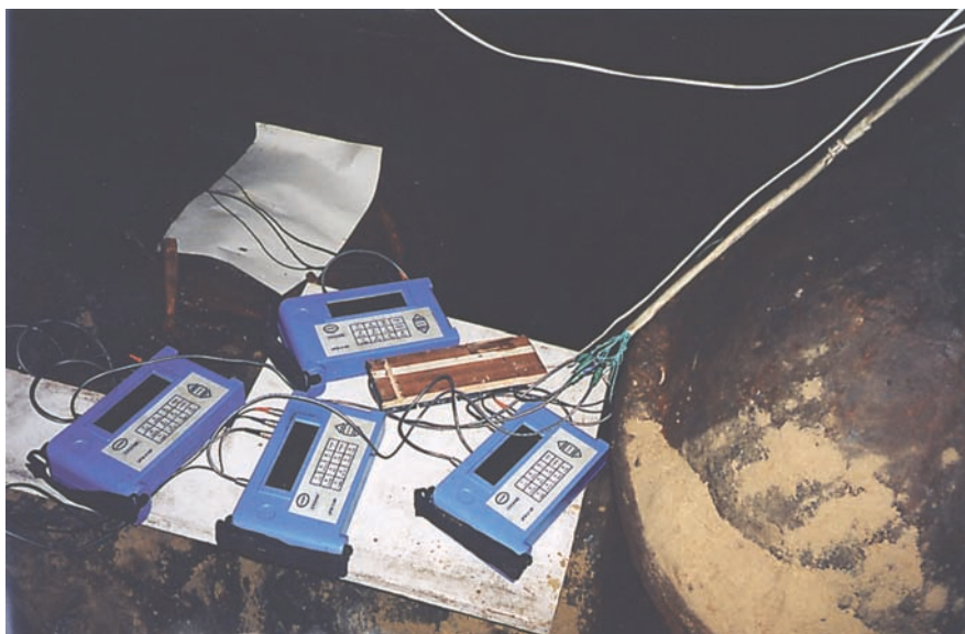
Рис. 2.14. Измерение узловых расходов воды в контрольном водопроводном колодце по ул. Ахсарова (Харьков) с помощью расходомеров UFM 610 р
