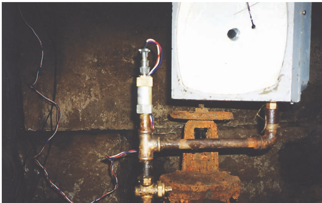
Рис. 2.16. Измерение давления воды тензорезисторным датчиком ДД и манометром МТС 712.Ч в диктующей точке сети по пр. Победы, 76 (Харьков)
