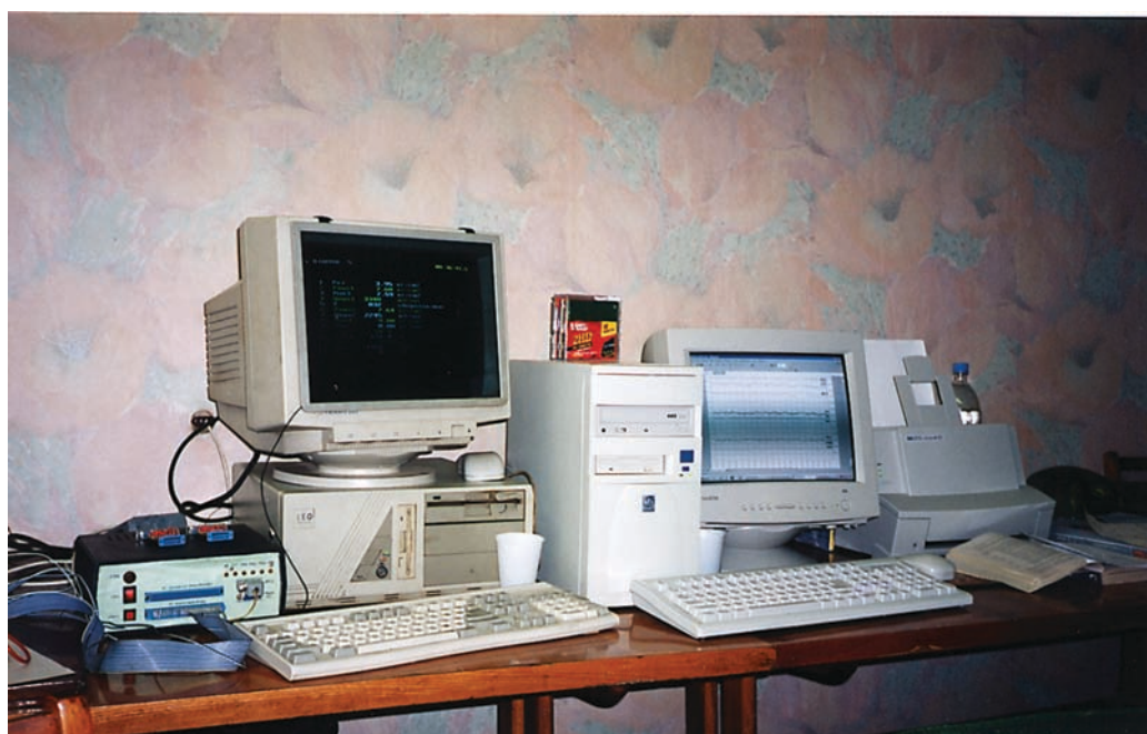
Рис. 2.13. Комплекс технических средств сбора, накопления и обработки информации при проведении экспериментов «Гидроудар» и «Авария» на насосной станции № 25А Харькова. Слева – аппаратура микроконтроллера КОМКОН
