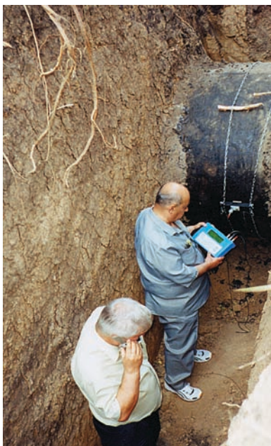
Рис. 2.2. Измерение скорости и расхода воды с помощью накладных расходомеров UFM 610 р
