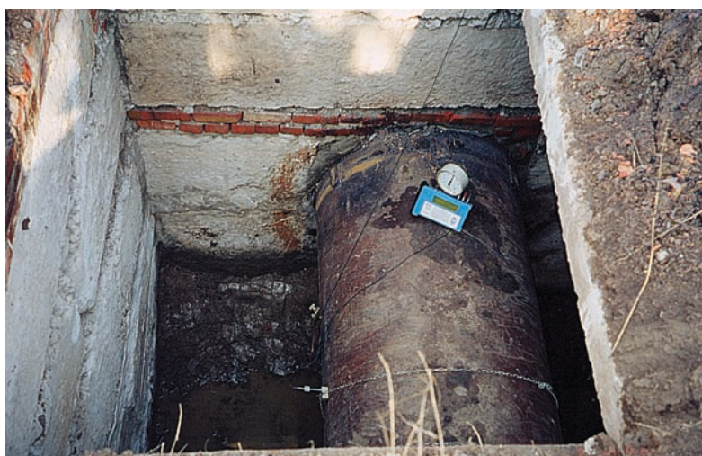
Рис. 2.5. Измерение скорости и расхода воды в водоводе диаметром 1400 мм
