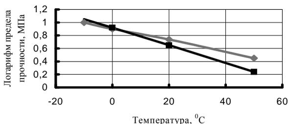
Температурная зависимость предела прочности при сжатии асфальтополимербетона на основе битума модифицированного 3 % полимером Kraton D-1101 (◇) и асфальтобетона на основе дорожного нефтяного битума марки БНД 90/130 (□)
