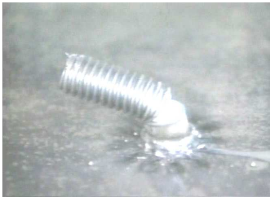
Рис.4 – Випробування зварного шва
