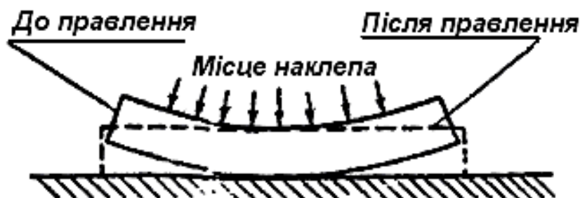
Рис. 11.2 – Схема правлення металевого бруска наклепом
