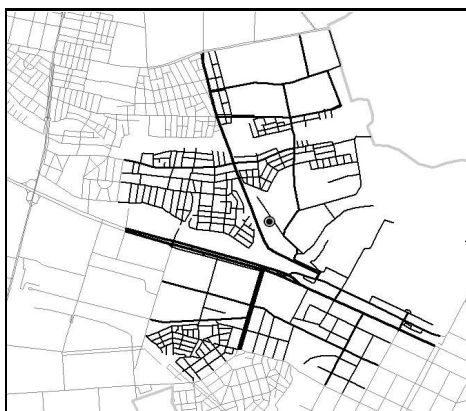
Рис. 5.7.5 - Сеть обслуживания дорог, удаленных по реальным путям до 3,5 км. от одного дорожно-эксплуатационного управления.
