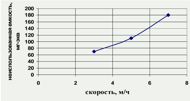
Зависимость неиспользованной емкости катионита от скорости фильтрации
