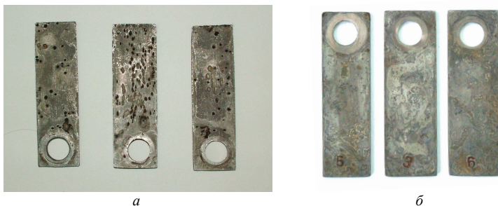
Рис.2. – Виды образцов углеродистой стали после испытаний в оборотной воде Харьковского коксового завода (время испытаний – 720 ч):
