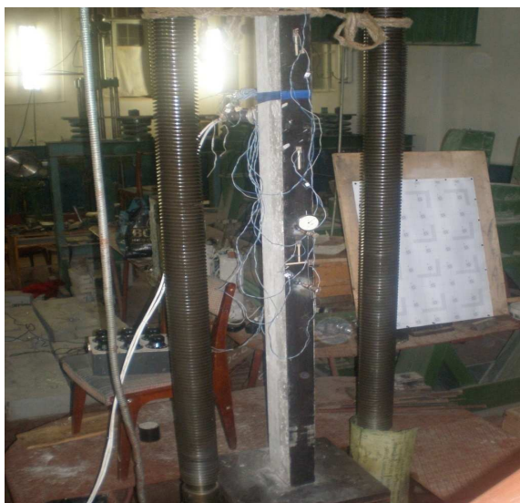
Рис.2 – Випробування сталезалізобетонної стійки висотою 2 м
