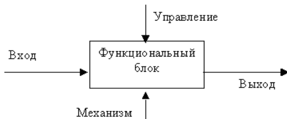
Рис.1 – Упрощенная модель функции/процесса по стандарту IDEF0
